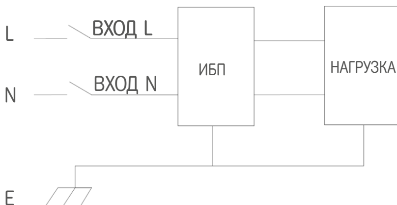
Рис. 3-3 Схема соединения на входе – «одна фаза + земля»
